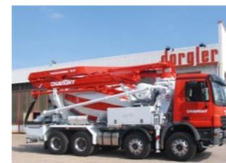
**Des camions malaxeur-tapis,** pouvant transporter du béton, équipés d'un tapis convoyeur, idéal pour livrer sur des chantiers difficiles d'accès (distance de la zone de coulage > 3m, dénivelé entre la toupie et la zone de coulage...).
